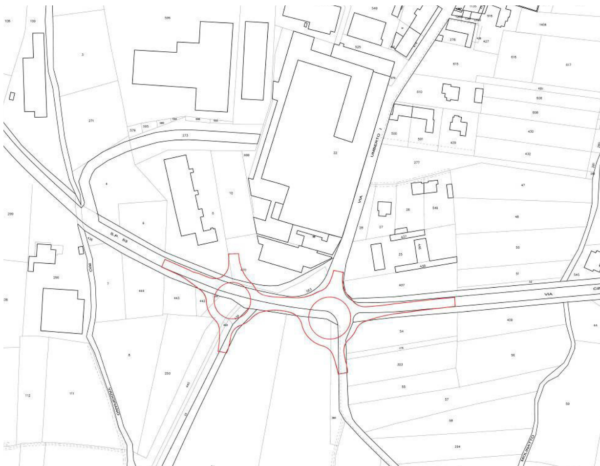
Indicazione progettuale della doppia rotatoria sulla SP53, in corrispondenza di Via Umberto I.
